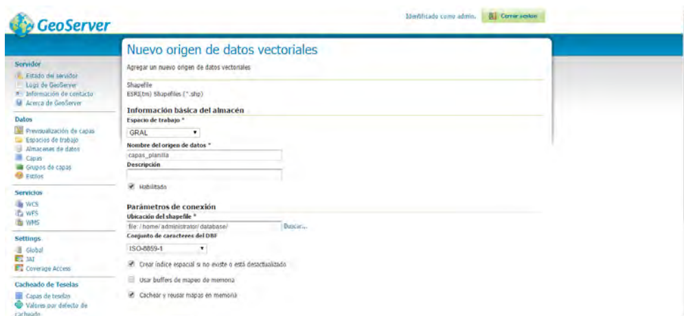
Figura 5.3: Ejemplo de la generación de nuevo origen de datos vectoriales en GeoServer
